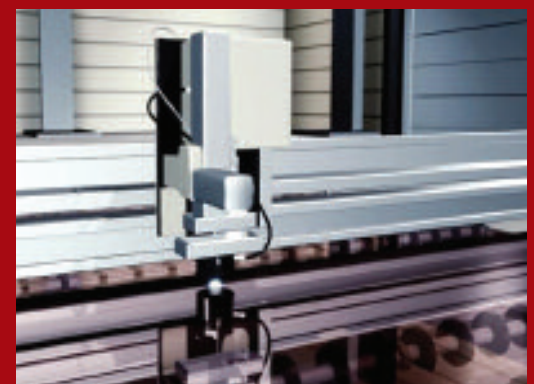
High Speed TRR: particolare che mostra la combinazione di spettrometri diodi array VIS/NIR serie CORONA PLUS (campo spettrale da 300nm a 1680) cui sono collegate via fibra ottica le teste di misure per trasmittanza/riflettanza spettrali
